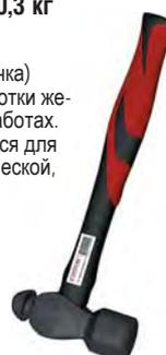
Предназначен для монтажных, сборочных работ, рихтовки и разгонки поверхности изделий из толстого металлического листа. Имеет металлическую ударную часть сферической формы, двухкомпонентная ручка, изготовленная из пластика и резины, предотвращает выскальзывание молотка при работе.
