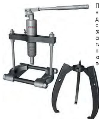
Применяется для демонтажа подшипников, шестерён, муфт, втулок, а также других деталей, которые имеют посадку с натягом. Трехточечный регулируемый захват обеспечивает чёткую фиксацию снимаемой детали. Преимущество гидравлического устройства перед механическим – существенно большее усилие, которое прикладывается к посадочным поверхностям.
