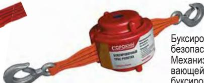
Буксировочный трос-рулетка – устройство для безопасной буксировки легкового автомобиля. Механизм снабжён пружиной, обеспечивающей постоянное натяжение троса при буксировке и его быстрое сматывание при торможении.
