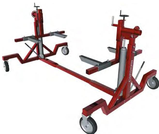
Кантователь кузова применяется для вывешивания, вращения и перемещения кузовов легковых автомобилей или корпусов небольших яхт. Конструкция кантователя регулируется по длине в соответствии с длиной кузова, подхваты регулируются по ширине. Подъемный механизм подхватов оборудован гидроцилиндром. Поворотный механизм позволяет производить вращение кузова на 360°.
