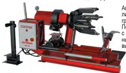
Автоматический шиномонтажный cтeнд с электрогидравлическим приводом. Используется для монтажа шин грузовых автомобилей, автобусов, тракторов и спецтехники. Позволяет работать с бескамерными шинами, с колёсами с глубокими и составными дисками. Все операции с подвижными частями станка производятся с помощью мобильного выносного пульта управления.
