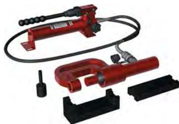
Наборы 6.144 и 6.145 предназначены для правки отдельных частей подвески. В наборах используется гидравлическая система, состоящая из гидравлического насоса и гидроцилиндра прямого действия. Специальные насадки подходят к деталям подвески легкового автомобиля с телескопическими линейками.
