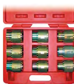
40.25 Комплект оправок для запрессовки сальника вилки Оправки для запрессовки сальников стандартных и перевернутых вилок мотоциклов: 35/36 мм (комбинированная), 46/47 мм (комбинированная), 49/50 мм (комбинированная), 39 мм, 41 мм, 43 мм, 45 мм, 48 мм, 54 мм, кейс.
